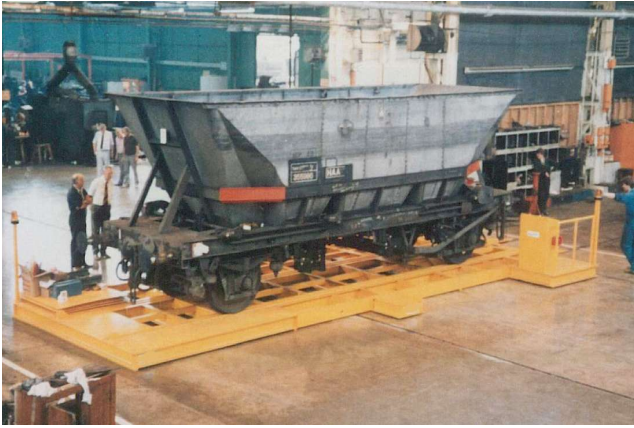
Waggonverschiebeanlage auf Luftfilm, 20 t
