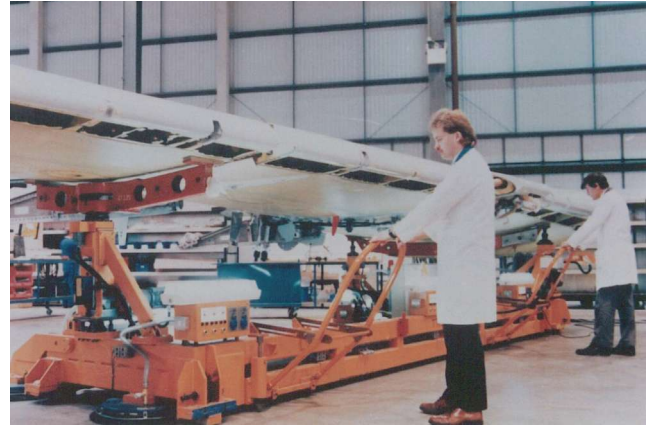
Montage von Flugzeugflügeln auf Luftfilm, 5 t
