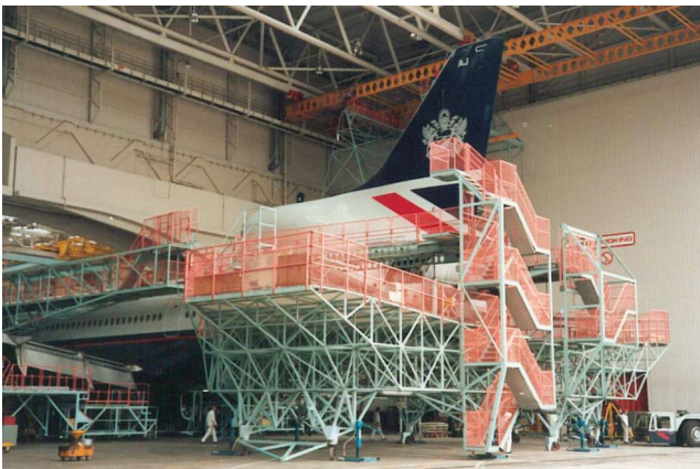
Wartungsgerüst auf Luftfilm zum positionieren
